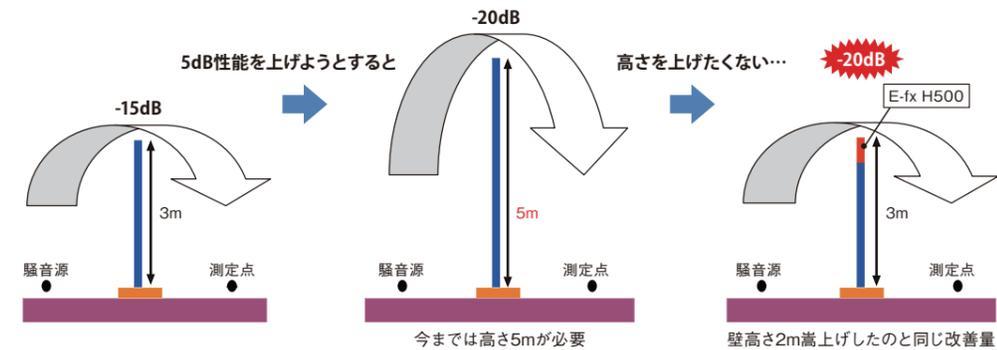
エッジ効果抑制型の効果量(自動車走行騒音A特性)125~1kHzまでの計算から算出
