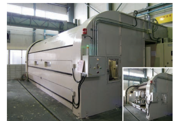
プラスト設備エンクロージャ
